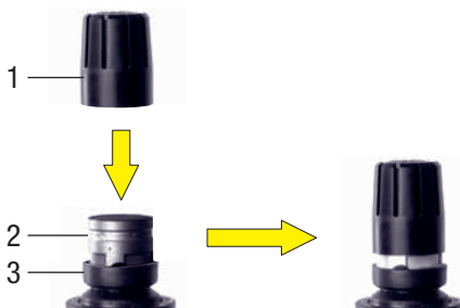
Figura 6: Come montare il PPC1000/PB1000
